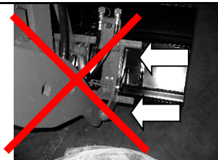
falsch Werkzeug muss richtig in den U-Profilen sitzen!
