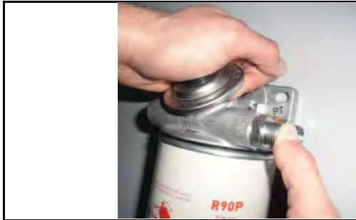
Foto 3: Pumpen, Zulauf verschlossen mit Daumen
