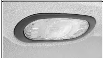
Leuchte durch Tür geschaltet:
