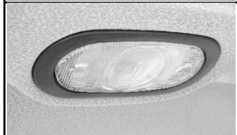
Leuchte durch Tür geschaltet:
