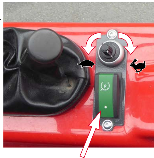
Interrupteur d'arrêt d'urgence du régulateur de vitesse
